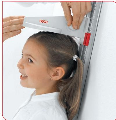
Mit der Feststellschraube wird das Ergebnis fixiert.
